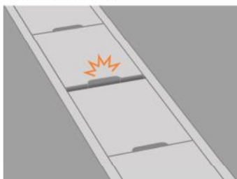
側溝の蓋のすき間
